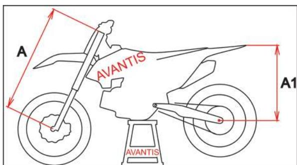
Снова поставьте питбайк на землю. Подвеска должна немного сжаться под весом питбайка. Попросите помощника удерживать питбайк в вертикальном положении. Измерьте повторно вертикальное расстояние между нижней и верхней точкой и запишите результат. (например, размер B1)
