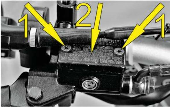
Установите тормозной цилиндр в горизонтальное положение и заполните бачок чистой тормозной жидкостью (DOT 4) до уровня (5 мм) ниже обода. (смотрите рисунок)
