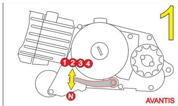
На рисунке [2] находится схема переключения передач для двигателей объемом 190cc.
