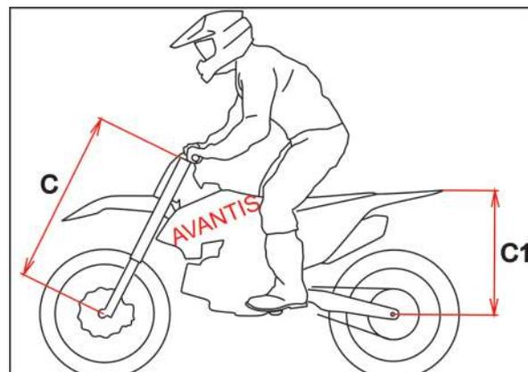
Значение ходового проседания должно быть в диапазоне 30 мм спереди и 50 мм сзади +/- 5 мм.
