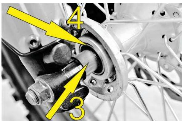
Затем установите переднее колесо в вилку и просуньте ось колеса [2] через кронштейны.
