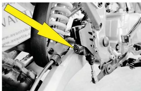
Если уровень тормозной жидкости ниже минимального значения, это значит, что в тормозной системе есть утечка или тормозные колодки полностью изношены!
